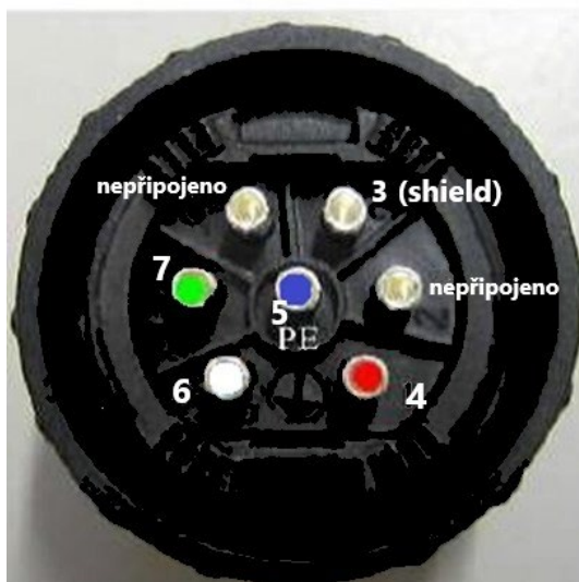
Obr. 5-3 Zapojení konektoru ultrazvukových senzorů (číslování dle legendy Obr. 5-4)
